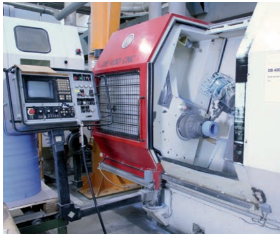
CNC-gesteuerte Drehmaschinen zur genauen Endbearbeitung.
