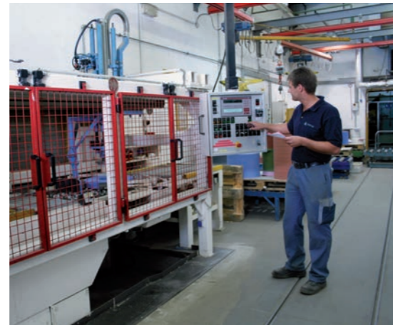
Computergesteuerte Prüfmaschinen zur Unwuchtkontrolle und für Probelaufgeschwindigkeitstests.
